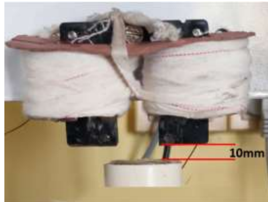
Fig. 15: Real time model of single coil AMB
